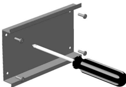
3.2.4 На закрепленную несущую DIN-рейку 105мм монтируется требуемое количество блоков шины БШ (но не более 32), которые соединяются между собой с помощью разъемов и образуют крейт контроллера. См. рисунок ниже:
