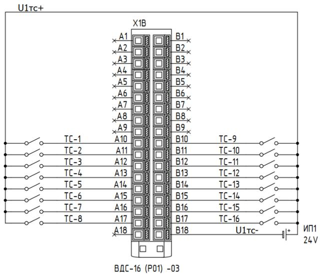
2.5.20 Типовые схемы подключения датчиков телесигнализации для субблока ВДС-16 (P02) ВНАР.426469.124 (с разъемом 36 конт.) представлена на рисунках ниже.
