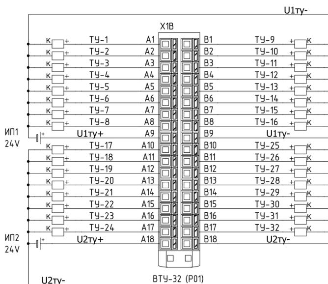
2.6.19 Типовая схема подключения исполнительных реле для субблока ВТУ-16 (P01) ВНАР.426469.142 представлена на рисунке ниже. Допустимо осуществлять питание исполнительных реле обеих групп от одного источника питания.
