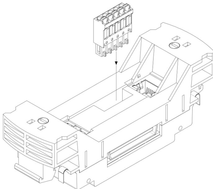
2.12.8 Пример установки блока БО на DIN-рейку 105мм в составе крейта контроллера представлен на рисунке ниже:
