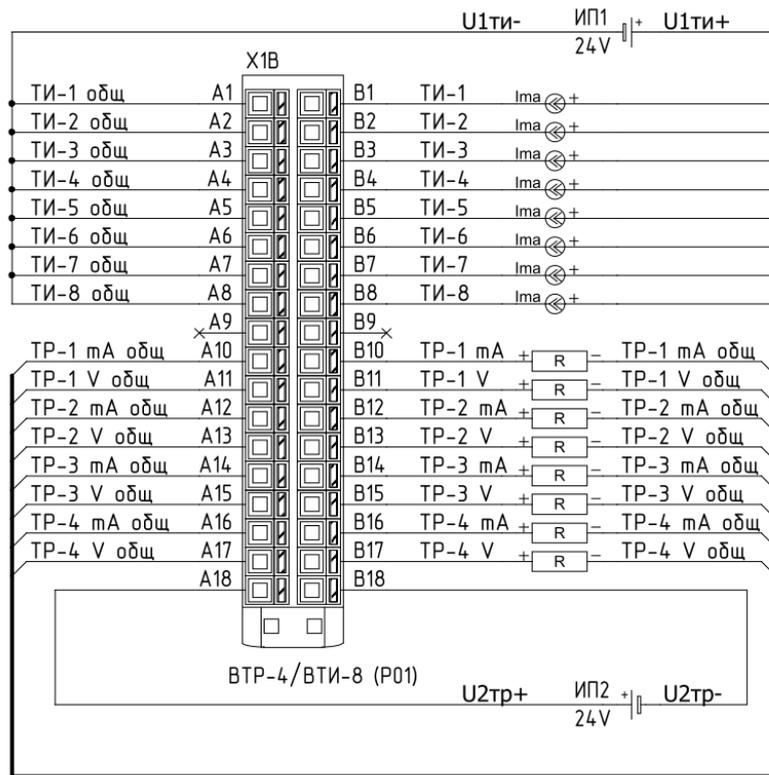
2.10.17 Типовая схема подключения датчиков телерегулирования и телеизмерения для субблока ВТР-4/ВТИ-8 (P01)-01 ВНАР.426469.151-01 представлена на рисунке ниже.
