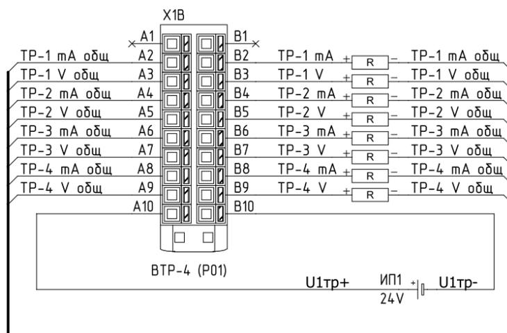
2.9.4 Типовая схема подключения датчиков телерегулирования для субблока ВТР-4 (P01)-01 ВНАР.426469.161-01 (СНЯТ С ПРОИЗВОДСТВА) представлена на рисунке ниже.
