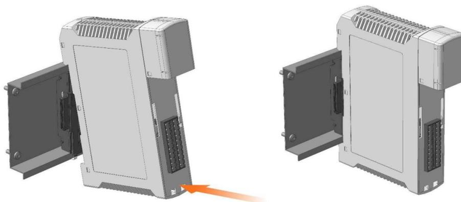
3.2.6 После установки субблоков ввода-вывода к ним, со стороны лицевой панели, подключаются съемные клеммные колодки для дальнейшего подключения сигналов от внешних датчиков. См. рисунок ниже:
