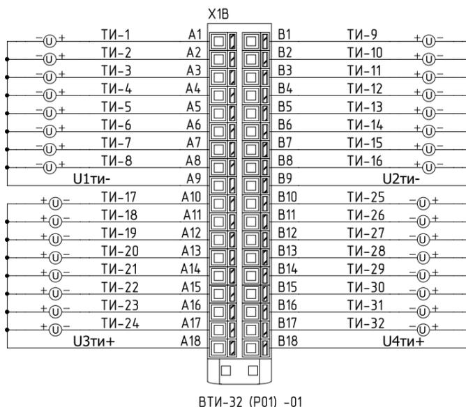
2.8.22 Типовая схема подключения датчиков телеизмерения для субблока ВТИ-32 (P01)-02 ВНАР.426469.131-02 представлена на рисунке ниже. Допустимо осуществлять питание датчиков от единого источника питания.
