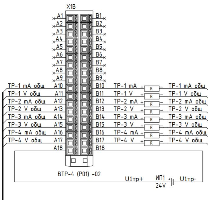
2.9.6 Типовая схема подключения датчиков телерегулирования для субблока ВТР-4 (P01)-03 ВНАР.426469.161-03 представлена на рисунке ниже.
