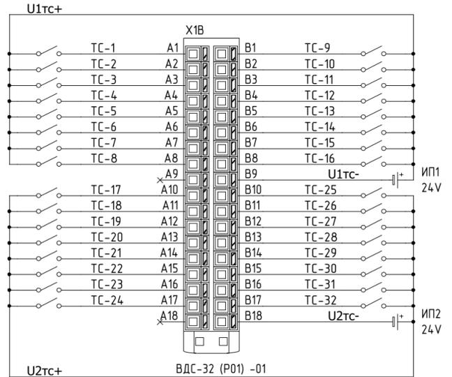
2.5.17 Типовые схемы подключения датчиков телесигнализации для субблока ВДС-32 (P02) ВНАР.426469.123 представлена на рисунках ниже. Допустимо осуществлять питание датчиков телесигнализации обеих групп от одного источника питания.
