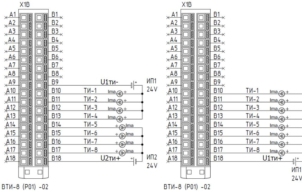
2.8.31 Типовые схемы подключения датчиков телеизмерения для субблока ВТИ-8 (P01)-03 ВНАР.426469.133-03 представлены на рисунке ниже. Допустимо осуществлять питание датчиков от единого источника питания.
