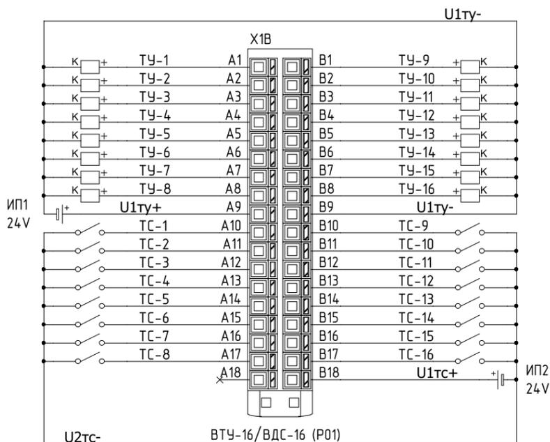
2.7.20 Типовая схема подключения исполнительных реле по цепям телеуправления и датчиков телесигнализации для субблока ВТУ-16/ВДС-16 (P01)-01 ВНАР.426469.171-01 представлена на рисунке ниже.
