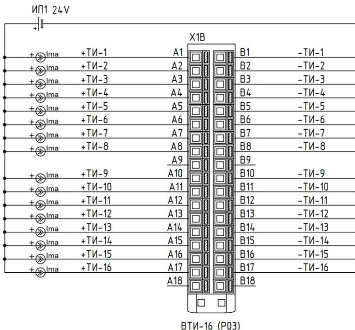
2.8.28 Типовые схемы подключения датчиков телеизмерения для субблока ВТИ-8 (P01) ВНАР.426469.133 (СНЯТ С ПРОИЗВОДСТВА) представлена на рисунке ниже. Допустимо осуществлять питание датчиков от единого источника питания.
