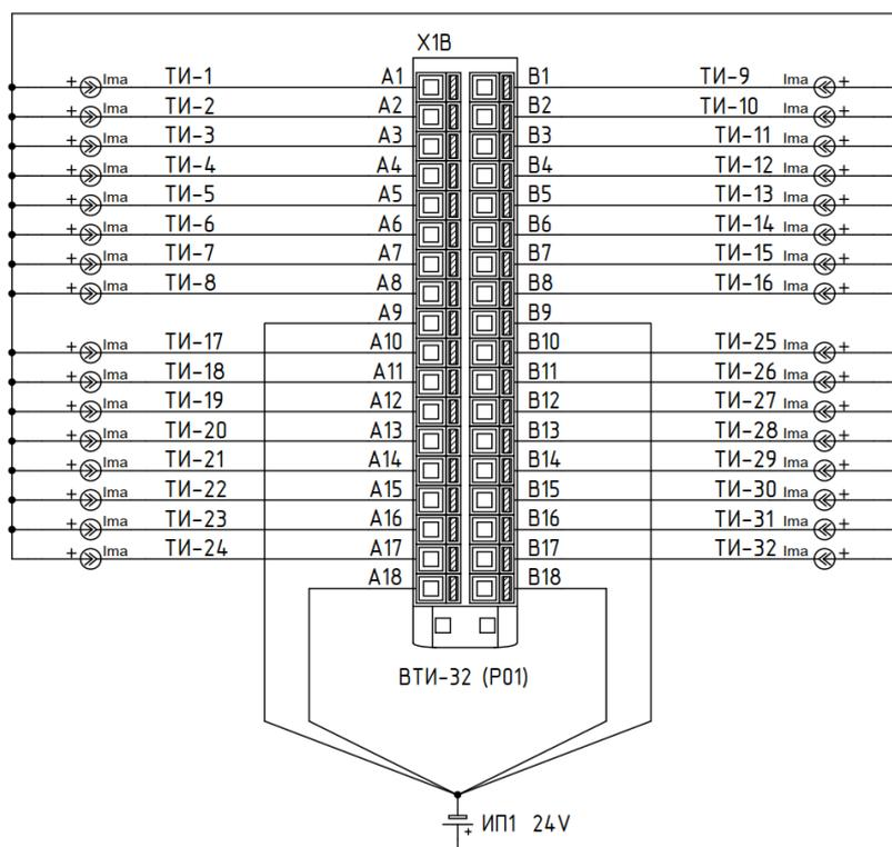
2.8.21 Типовая схема подключения датчиков телеизмерения для субблока ВТИ-32 (P01)-01 ВНАР.426469.131-01 представлена на рисунке ниже. Допустимо осуществлять питание датчиков от единого источника питания.
