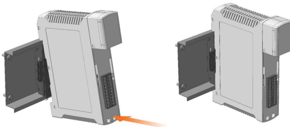
1.3.29 После установки субблоков ввода-вывода к ним, со стороны лицевой панели, подключаются съемные клеммные колодки для дальнейшего подключения сигналов от внешних датчиков. См. рисунок ниже:
