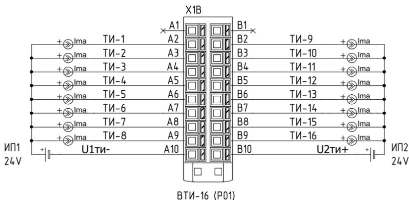
2.8.24 Типовая схема подключения датчиков телеизмерения для субблока ВТИ-16 (P01) -01 ВНАР.426469.132-01 (СНЯТ С ПРОИЗВОДСТВА) представлена на рисунке ниже. Допустимо осуществлять питание датчиков от единого источника питания.
