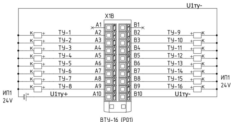
2.6.20 Типовая схема подключения исполнительных реле для субблока ВТУ-16 (P01) -01 ВНАР.426469.142-01 представлена на рисунке ниже. Допустимо осуществлять питание исполнительных реле обеих групп от одного источника питания.
