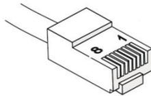
2.3.26 Разъемы RJ-45 для подключения каналов Ethernet снабжены двумя светодиодами: желтым и зеленым. Зеленый индикатор светится, когда есть активные посылки в линии Ethernet. Желтый индикатор светится, когда по линии Ethernet обмен осуществляется на скорости 100 Мбит/с (при 10 Мбит/с данный индикатор не горит).
