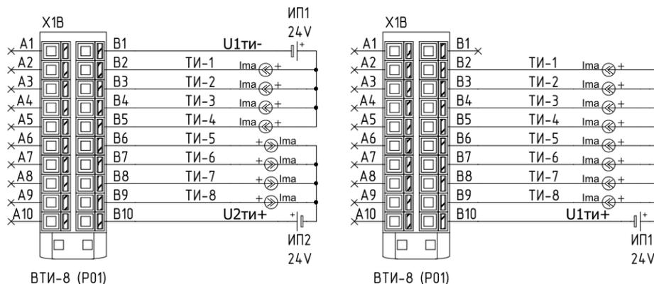
2.8.29 Типовые схемы подключения датчиков телеизмерения для субблока ВТИ-8 (P01)-01 ВНАР.426469.133-01 (СНЯТ С ПРОИЗВОДСТВА) представлена на рисунке ниже. Допустимо осуществлять питание датчиков от единого источника питания.
