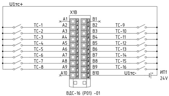
2.5.19 Типовые схемы подключения датчиков телесигнализации для субблоков ВДС-16 (P01) -02 ВНАР.426469.122-02 (с разъемом 36 конт.) и ВДС-16 (P01) -03 ВНАР.426469.122-03 (с разъемом 36 конт.) представлена на рисунках ниже.
