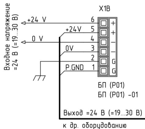
**ПРИМЕЧАНИЕ:** Внутри блока БП (P01), БП (P03) контакты входного разъемного клеммника 1-2, 3-4 и 5-6 между собой замкнуты на уровне печатной платы блока.
