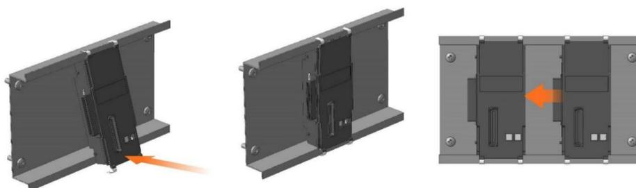
3.2.5 После этого монтируются блоки/субблоки, т.е. к блокам шины подключаются блоки/субблоки. См. рисунок ниже:
