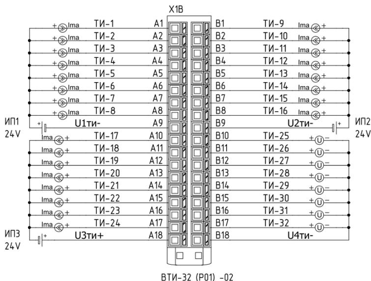
2.8.23 Типовая схема подключения датчиков телеизмерения для субблока ВТИ-16 (P01) ВНАР.426469.132 (СНЯТ С ПРОИЗВОДСТВА) представлена на рисунке ниже. Допустимо осуществлять питание датчиков от единого источника питания.
