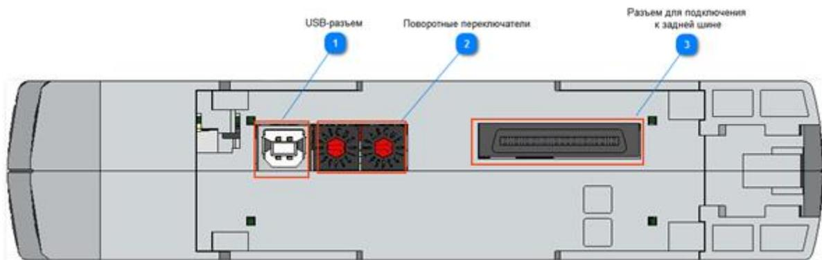
1.3.24 Блок шины имеет пластиковый корпус, на передней панели которого расположена ответная часть блочного разъема. По бокам располагаются разъемы, обеспечивающие коммутацию блоков шины между собой. Сверху и снизу блоков шины расположены металлические усики, обеспечивающие крепление блоков шины на несущей DIN-рейке и его заземление.
