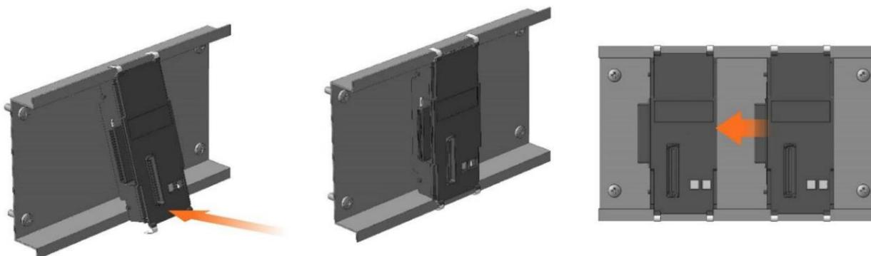
1.3.28 После этого монтируются блоки/субблоки, т.е. к блокам шины БШ подключаются блоки/субблоки. См. рисунок ниже:
